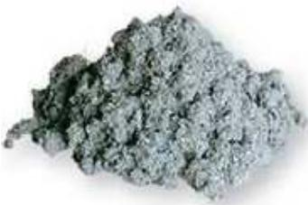
**Pour planchers et combles perdus.** Issue du recyclage de journaux et traitée au sel de bore contre les insectes et les rongeurs, elle est idéale pour l'isolation par épandage mécanique ou manuel. Inflammable. Euroclasse C
