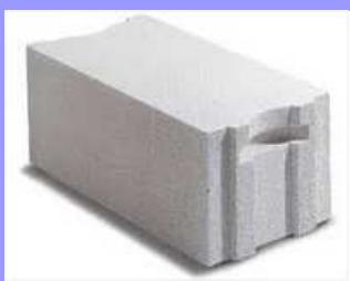
C'est un matériau léger, un mélange de ciment, de chaux, de sable et d'eau, auquel est ajoutée de la poudre d'aluminium qui lui donne des propriétés "aérées". L'air, emprisonné sous forme de petites bulles, apporte au béton cellulaire ses qualités d'isolation.
